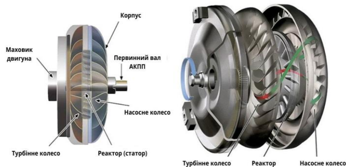
Мал.2 Гідротрансформатор
